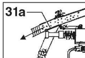
Выход тех. колеи (31 a) открыт, посевной материал попадает в почву.
