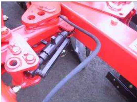
При изменении рабочей ширины необходимо корректировать и угол (направление) колеса.. При помощи регулировочного рычага нужно выровнять ось направления колеса с осью
