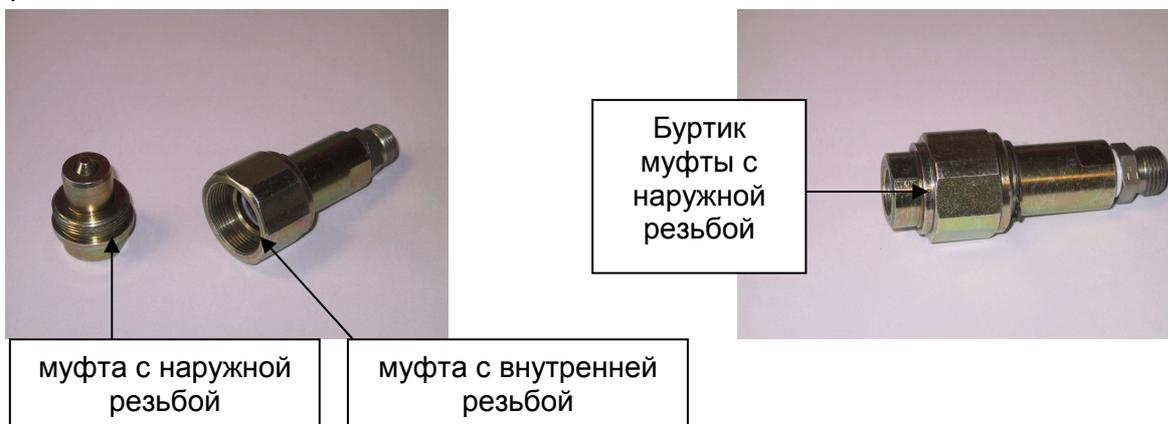
При плохо затянутой муфте обязательно будет значительное ухудшение срабатывание защиты дополнительных корпусов, так как гидравлическое масло не сможет возвращаться в гидропневмоаккумулятор в случае прохождения препятствия.
