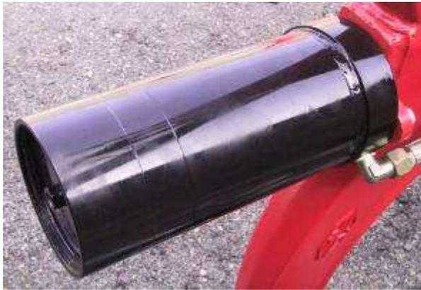
В стандартной сборке диаметр гидроцилиндров 90 мм.
