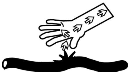
Рабочие жидкости в гидравлических системах плуга находятся под давлением, достаточным для нанесения серьезных травм при попадании в глаза и проникновения под кожу, в случае утечек.
