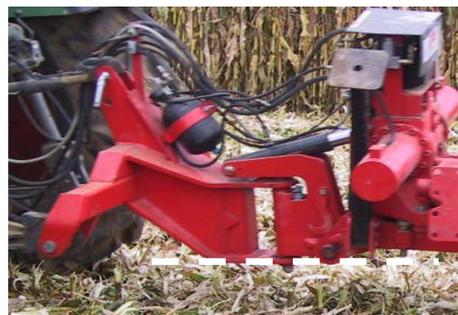
Положение 3-ей точки регулируется, когда трактор идет в борозде (второй проход) при заглубленном плуге в работе. 3-я точка должна всегда быть выше со стороны плуга – обычно на 1 отверстие выше горизонтали ( $X < Y$ ).
