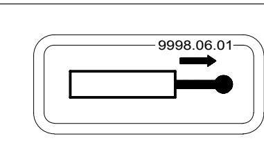
9998.06.01                                                                                       | <p>Посока на протичане на маслото:протичане напред „Повдигане“.</p>                                                                              |
