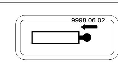
9998.06.02                                                                                       | <p>Посока на протичане на маслото: Назад „Спускане“ респ. „към резервоара“.</p>                                                                  |
