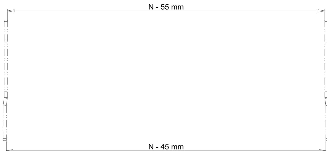
N = Nennbreite Gerät [ mm ]
