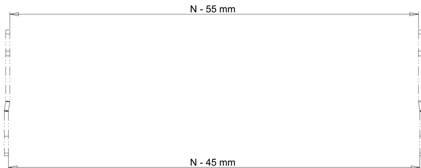
N = Nennbreite Gerät [ mm ]
