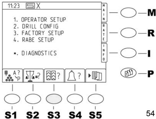
Durch Drücken der Taste <P> für die Parameter-Menüseiten erscheint Bildschirm (54). Danach gelangt man durch drücken der Taste <3>, auf dem Zahlenfeld, in das Menü Werkseinstellungen. Hier sind verschiedene Einstellungen 4.3.3.1 bis 4.3.3.4 möglich.
