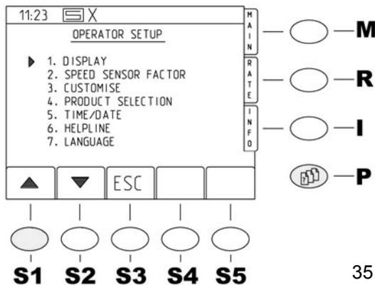
Durch Drücken der Taste <P> für die Parameter-Menüseiten erscheint Bildschirm (34). Danach gelangt man durch drücken der Taste <S1>, auf dem Zahlenfeld, in die Bediener-Einstellungen (35). Hier sind verschiedene Einstellungen 4.1.1 bis 4.1.7 möglich.
