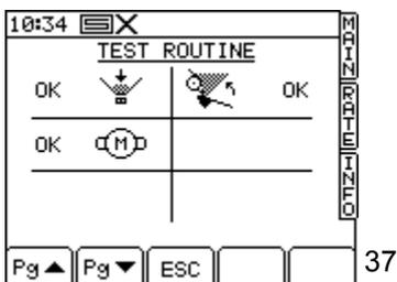
Wenn alle Funktionen die Prüfung mit OK bestanden haben, erscheint der Bildschirm (39). Mit der Enter-Taste erfolgt die Rückkehr zum Rabe Setup Menü.
