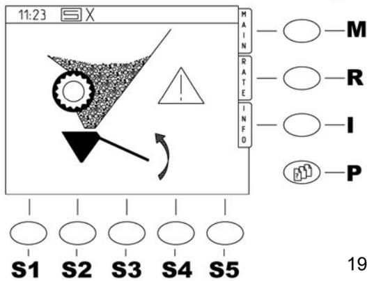
Analog der Bedienung bei der Saatgutauswahl kann jetzt der Signalpfeil auf die Zeile T.K.G. (Tausendkorngewicht) und Aussaatmenge bewegt werden.
