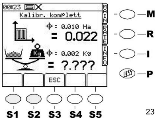
Die Anzeige wechselt dann von allein zur vorherigen Anzeige für eine neue Abdrehsprobe. Nach Beendigung der Abdrehung fragt die Steuerung (23) nach der abgedrehten Menge. Die Anzeige zeigt gross den **prognostizierten** Wert für das abgedrehte Saatgut.
