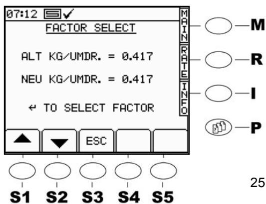
Um eine weitere Abdrehprobe (Kontrolle) durchführen zu können die <ESC> Taste drücken. In (25) wird noch mal die Abweichung in % angezeigt, mit <Enter> bestätigen.
