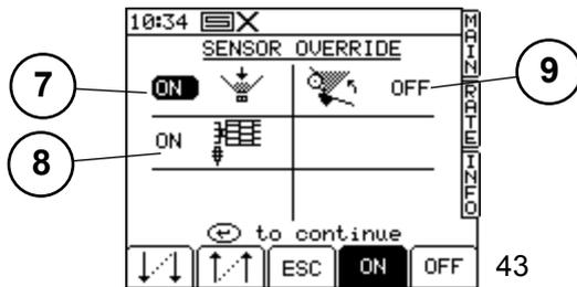
Taste I dient dazu, die Auswahl in der linken Spalte nach unten, anschließend nach oben rechts und dort wieder nach unten zu verschieben. Taste H arbeitet in umgekehrter Richtung. Wenn die gewünschte Position gewählt ist, kann sie mit den Tasten E und F ein- bzw. ausgeschaltet werden. (42,43)
