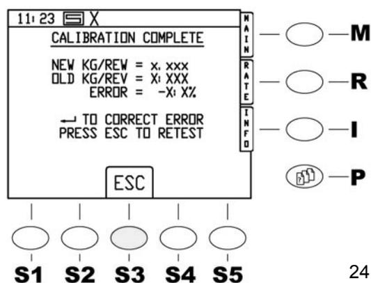
Jetzt wird das **gewogene** Gewicht der Abdrehprobe in kg über das Tastenfeld eingegeben! (23). Bei zwei Dosiergehäusen beide Eimer zusammen verwiegen. Dazu den Zahlenblock an der Steuerung benutzen und mit <Enter> den Wert in die Anzeige übernehmen. **Das gewogene Gewicht darf mathematisch nicht bearbeitet werden!**
