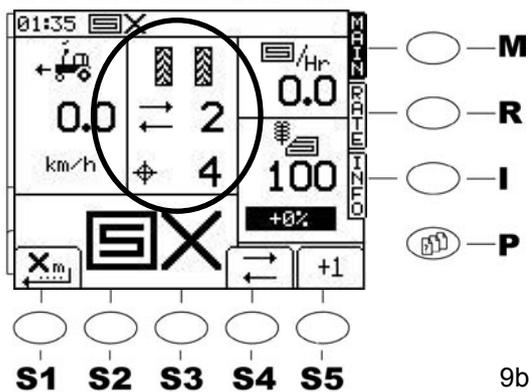
**b) Anzeige des Fahrgassenrhythmus und des aktuellen Fahrgassenzustandes (9b):**
