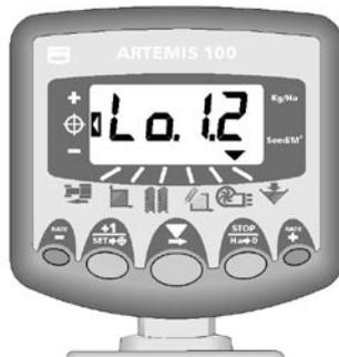
Abbildung 25: Beide Tankanzeigen niedrig
