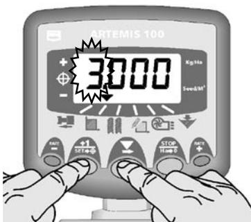
Abbildung 10: Breite des Geräts ändern
