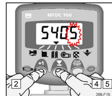
Abb. 15: Fahrgassenspur eingeben
