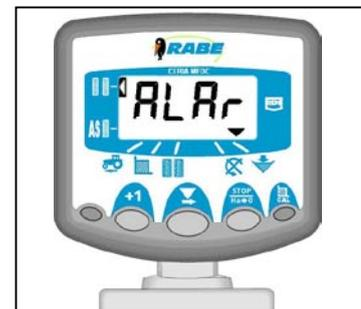
Abb. 20: Alarm Saatgutfüllstand
