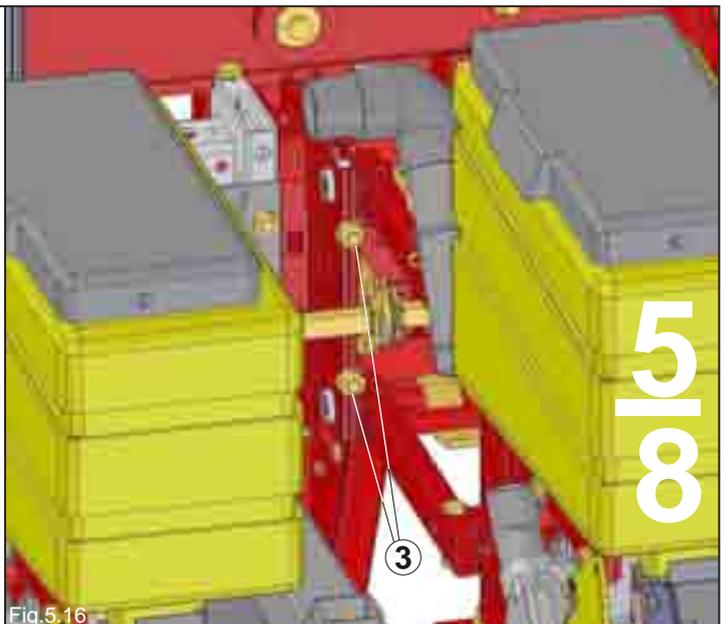
5) Die Säelemente (5 und 8) entfernen und die Saugrohre von den Elementen abziehen und mit Stopfen verschließen
