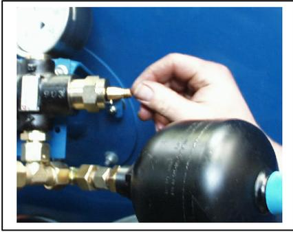
5. Messingspannhülse aufsetzen – dabei liegt der Konusanschlag links vom LS – Ventilanschlag Anschlagzapfen siehe 4.
