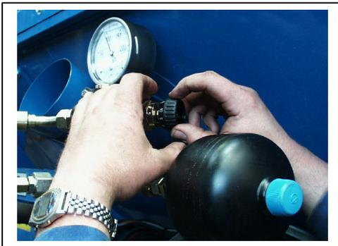
7. Drehgriff auf Messingspannhülse aufsetzen.
