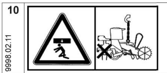
Опасность для жизни со стороны подвешенных грузов. Крепить "Multidrill A" только за проушину для транспортировки.
