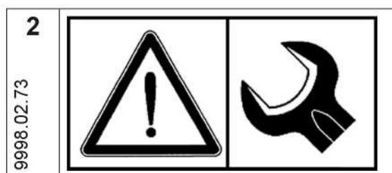
После первой эксплуатации подтянуть все болты; затем регулярно контролировать прочность их посадки. Специальные моменты затяжки приводятся в инструкции по эксплуатации или в спецификации запчастей. Использовать динамометрический гаечный ключ.
