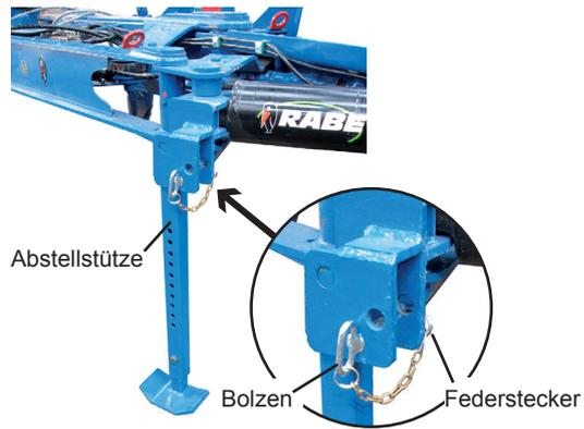
Bevor die Abstellstütze hochgeklappt werden kann, muß die Maschine mit dem Dreipunktkraftheber ein wenig angehoben werden.
