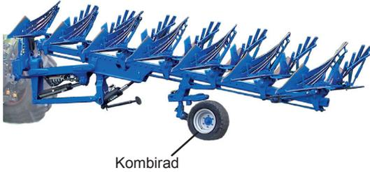
Die Maschine hinten [mit dem Kombirad] und vorne [mit dem Dreipunktkraftheber] so anheben, daß der Rahmen waagrecht ausgehoben ist.
