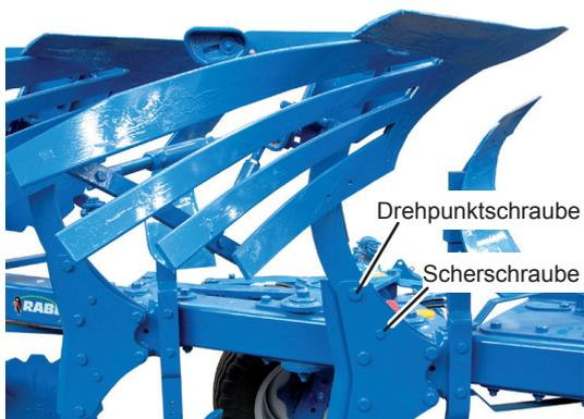
Ist der ausgeschwenkte Körper „blockiert“, die Drehpunktschraube etwas lösen.
