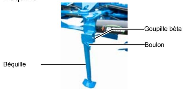
Avant de pouvoir relever la béquille, la machine doit être légèrement soulevée à l'aide du relevage à trois points.
