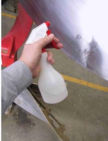
Dans les régions où la terre est particulièrement collante, il est parfois bien utile de déposer un léger film d'huile sur les versoirs dès la sortie du champ (même pour un arrêt de quelques heures). Utiliser un atomiseur avec une huile fluide de type WD 40 qui existe aussi en aérosols.
