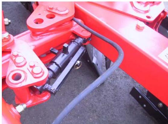
Lorsque l'on modifie la largeur de travail, l'angle de la roue doit être corrigé. A l'aide du bras de réglage, aligner l'axe de la roue avec l'axe des âges.
