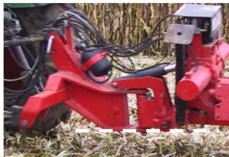
La position du 3<sup>ème</sup> point se règle lorsque le tracteur est dans la raie (2<sup>ème</sup> passage) avec la charrue en terre. Au travail, le 3<sup>ème</sup> point doit toujours être plus haut du côté de la charrue, généralement 1 trou au dessus de l'horizontal ( $X < Y$ ).
