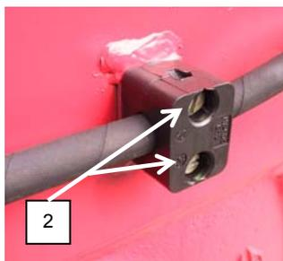
Les vibrations au transport ou au travail peuvent provoquer un desserrage des vis de fixation (1 et 2) des supports de flexibles ou tuyaux rigides hydrauliques.
