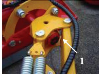
**Prêtez particulièrement attention à la fixation du bras (Illustration 11/1) , n'hésitez pas à resserrer les écrous si besoin est.**
