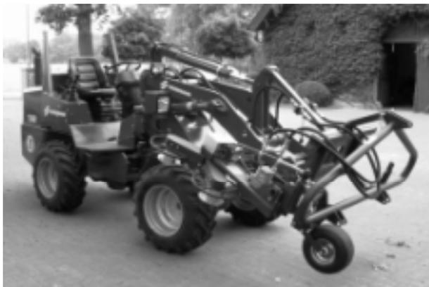
Abb. 9: Mäher in Transportstellung im Frontbetrieb
