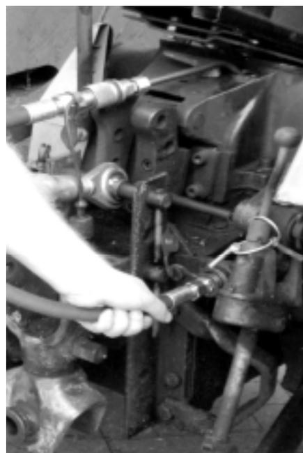
Abb. 5: Anschließen der Hydraulikleitungen
