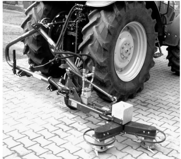
Abb. 8: Mäher in Arbeitsstellung im Heckbetrieb
