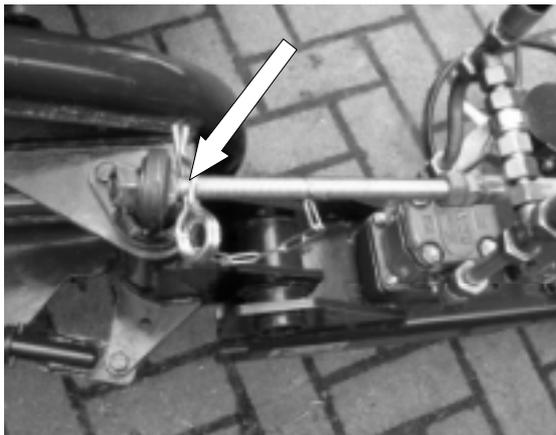
Abb. 24 : Sicherung des Spannschlusses mit Hilfe des Federsteckers
