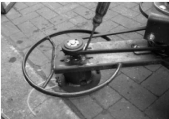
Abb. 32: Keilriemen spannen
