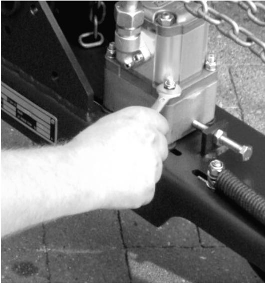
Lösen Sie die 4 Schrauben des Vorsatzlagers (siehe Abb. 33)
