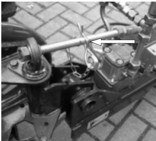
Abb. 17: Federstecker am Spannschloss in Arbeitsstellung (bei nicht federentlasteter Einklappvorrichtung)
