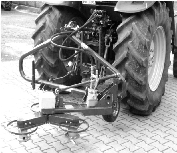
Abb. 7: Mäher in Transportstellung im Heckbetrieb
