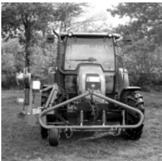
Abb.11: Mäher in Transportstellung mit federentlasteter Einklappvorrichtung
