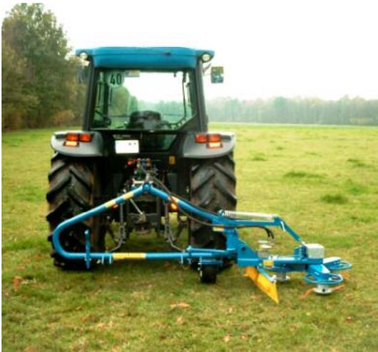
Abb. 9: Mäher in Arbeitsstellung im Heckanbau
