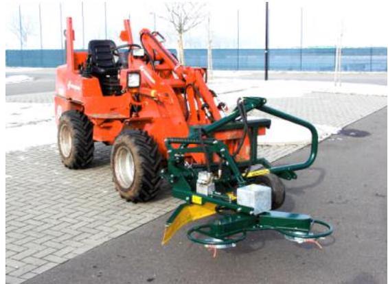
Abb. 8: Mäher in Transportstellung horizontal nach vorne
