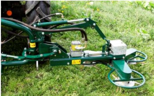
Abb. 5: Hydraulische Aushebung
