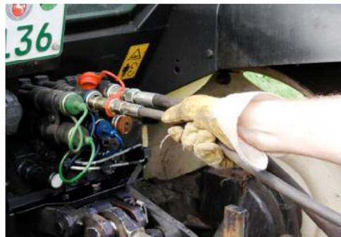
Abb. 5b: Anschließen der Hydraulikleitung
