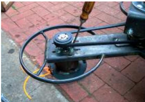
Abb. 32: Keilriemen spannen
