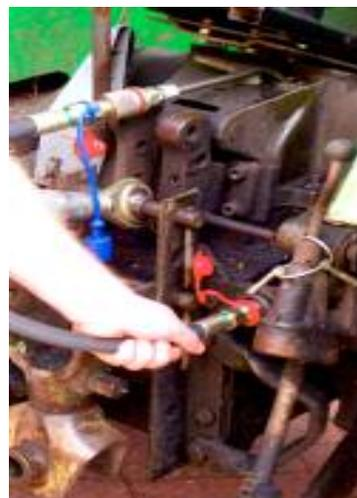
Abb. 4b: Anschließen der Hydraulikleitungen
