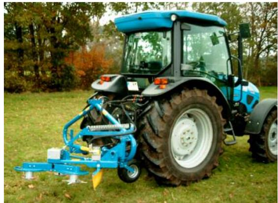
Abb. 10: Mäher in Transportstellung im Heckanbau
