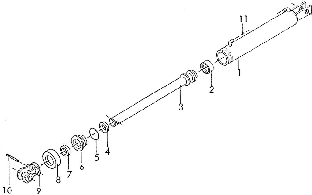
Gerätetyp: Zylinder  $\varnothing$  80 für GH(F) 385,470
