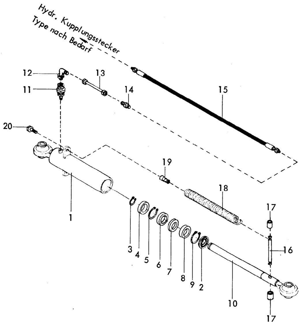
**Montage :** Teile 2,9,8,7,6,5 und 4 in vorstehender Reihenfolge auf die Kolbenstange schieben, Sprengring 3 aufsetzen. Kolbenstange in das Zylinderrohr 1 einschieben und Sprengringe 5 und 9 im Zylinderrohr einrasten lassen.
