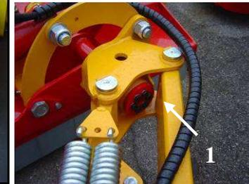
**Besondere aufmerksamkeit bei der Befestigung der Schrauben auf dem Arm-Anbau (siehe Abb. 11/1) legen. Sind die Schrauben locker- nachziehen!**
